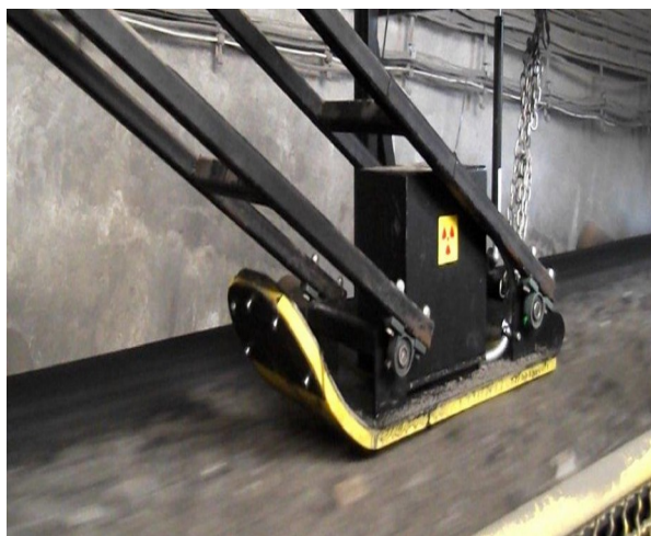
Spektrometr mierzący produkt na podajniku taśmowym
