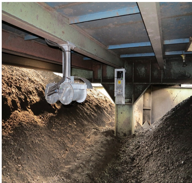
System monitorujący zapylenie w kopalni. Detektor oraz emiter promieniowania (wykonanie ATEX)
