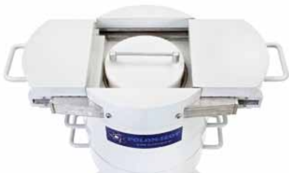
Widok komory pomiarowej z pojemnikiem zawierającym badaną próbkę przed jej zamknięciem.
