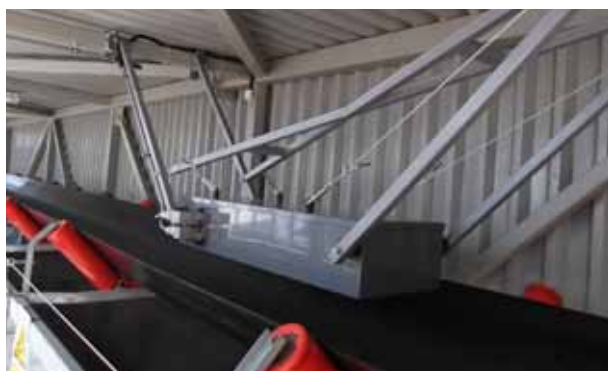
System PI-TW 04 montowany nad podajnikami taśmociągowymi
