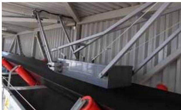
System PI-MSKA montowany nad podajnikami taśmociągowymi
