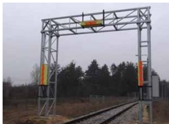
System PI-MSKA z dwoma detektorami umieszczonymi naprzeciwko siebie
