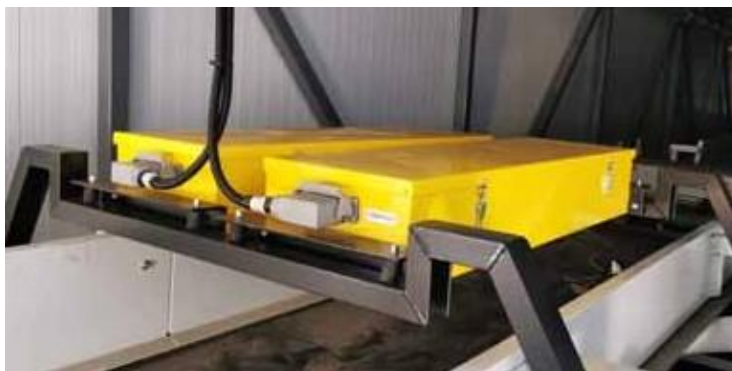
System PI-MSKA montowany nad podajnikami taśmociągowymi
