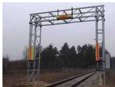
System kolejowy PI-MSKA z detektorem górnym i dwoma detektorami umieszczonymi naprzeciwko siebie
