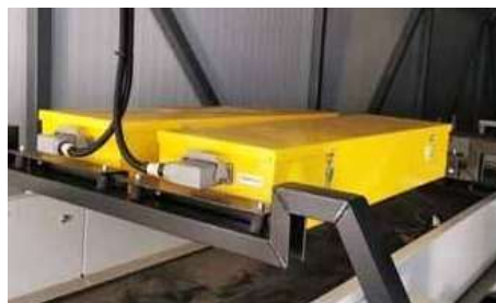
System PI-MSKA montowany nad podajnikami taśmociągowymi
